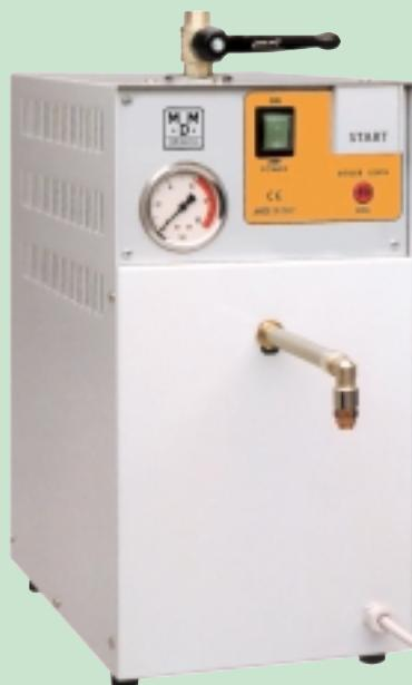
Il getto di vapore rappresenta un metodo di pulitura efficace per ravvivare e lucidare i campionari, pulire i modelli dai residui di cera, sgrassare gli oggetti, eliminare le tracce dei disossidanti per la saldatura, eliminare residui di rivestimento per fusione.
